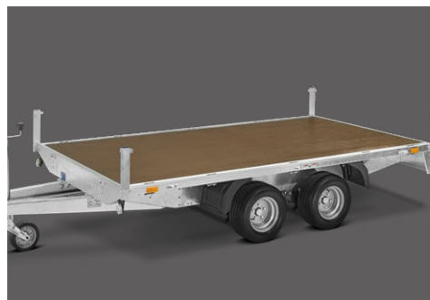
Bis Innenmaß 5220 x 2070 mm Bodenplatte aus einem Stück
