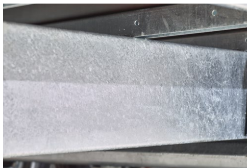
Rahmen und Fahrgestell Tauchbad feuerverzinkt
