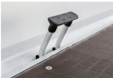
Serienmäßig im Außenrahmen integrierte Zurrbügel
