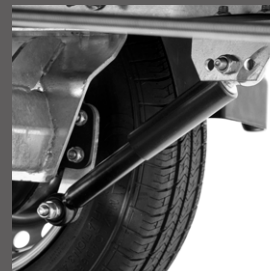
Radstoßdämpfer (montiert) inkl. 100 km/h Bestätigung*
