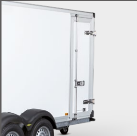
Seitentür mit Drehstangen- verschluss von Innenhöhe 1500 - 2300 mm
