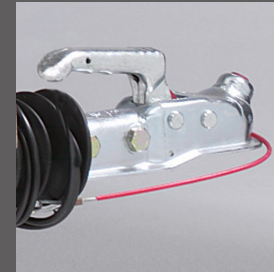
Kugelkopfkupplung für höhenverstellbare Zugdeichsel
