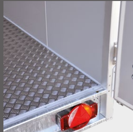
Bodenplatte mit Alu-Riffelblech belegt
