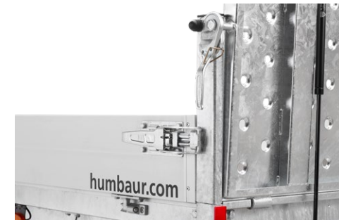
Tauchbad feuerverzinkte Eckungen und Spannverschlüsse
