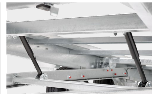
Stoßdämpfer für die mechanischen Kippfunktion
