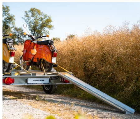
1 Auffahrschiene im Bohlenschacht integriert
