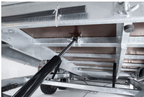
Besondere Stabilität durch Doppelhutprofile in Querrichtung an der Brücke
