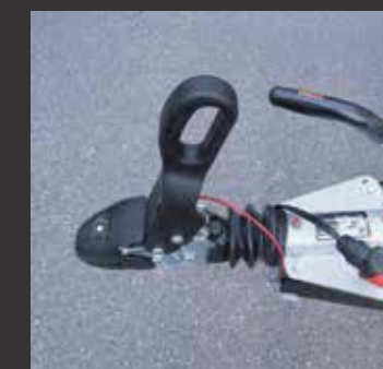
Sicherheitskupplung mit Spurstabilisierung
