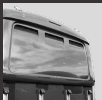
GFK-Windflap mit integrierter dritter Bremsleuchte (optional) für Xanthos®, Zephir® und Maximus®
