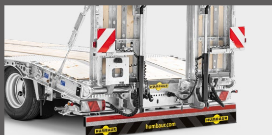
1-teilige hydraulische Rampen mit hydraulischer Seitenverschiebung
