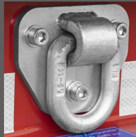
In den Außenrahmen integrierter Zurrpunkt bis 3 000 kg Zugkraft
