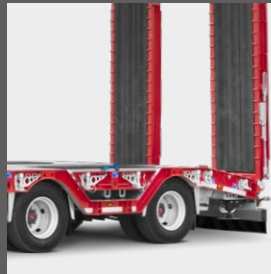
Außenrahmen feuerverzinkt und lackiert nach RAL
