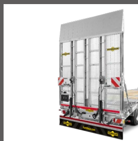
Stahlüberfahrwand über die gesamte Breite mit Gitterrostbelag
